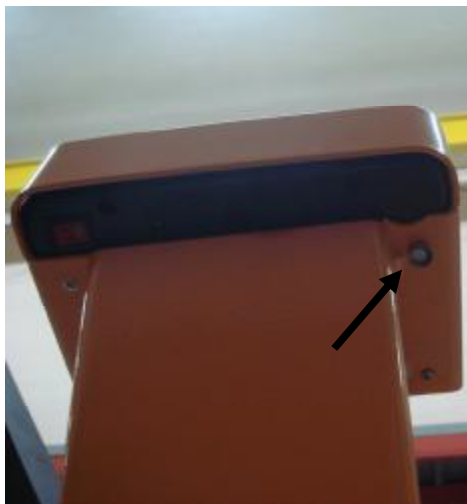
Рисунок 3 Схема пломбировки от несанкционированного доступа и обозначение места для нанесения оттиска клейма.
