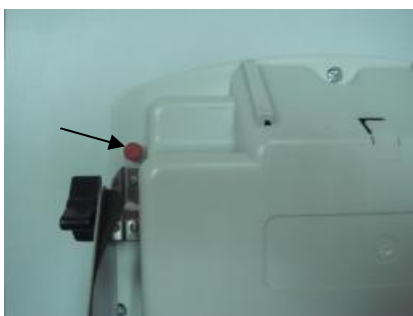
Рисунок 4 – Схема пломбирования компараторов от несанкционированного доступа
