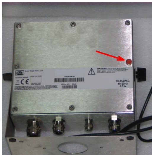
Рисунок 3. Схема пломбировки от несанкционированного доступа и обозначение места для нанесения оттиска клейма.
