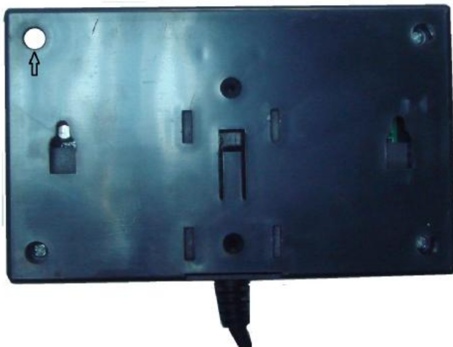
Рисунок 3 Схема пломбировки от несанкционированного доступа и обозначение места для нанесения оттиска клейма.
