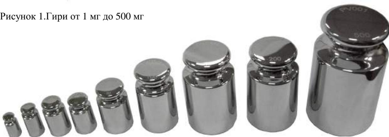
Рисунок 2.Гири от 1 г до 20 кг цилиндрические
